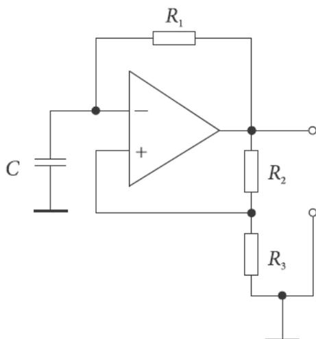
Рис. 1. Симметричный мультивибратор. Питание от симметричного двуполярного источника питания.
