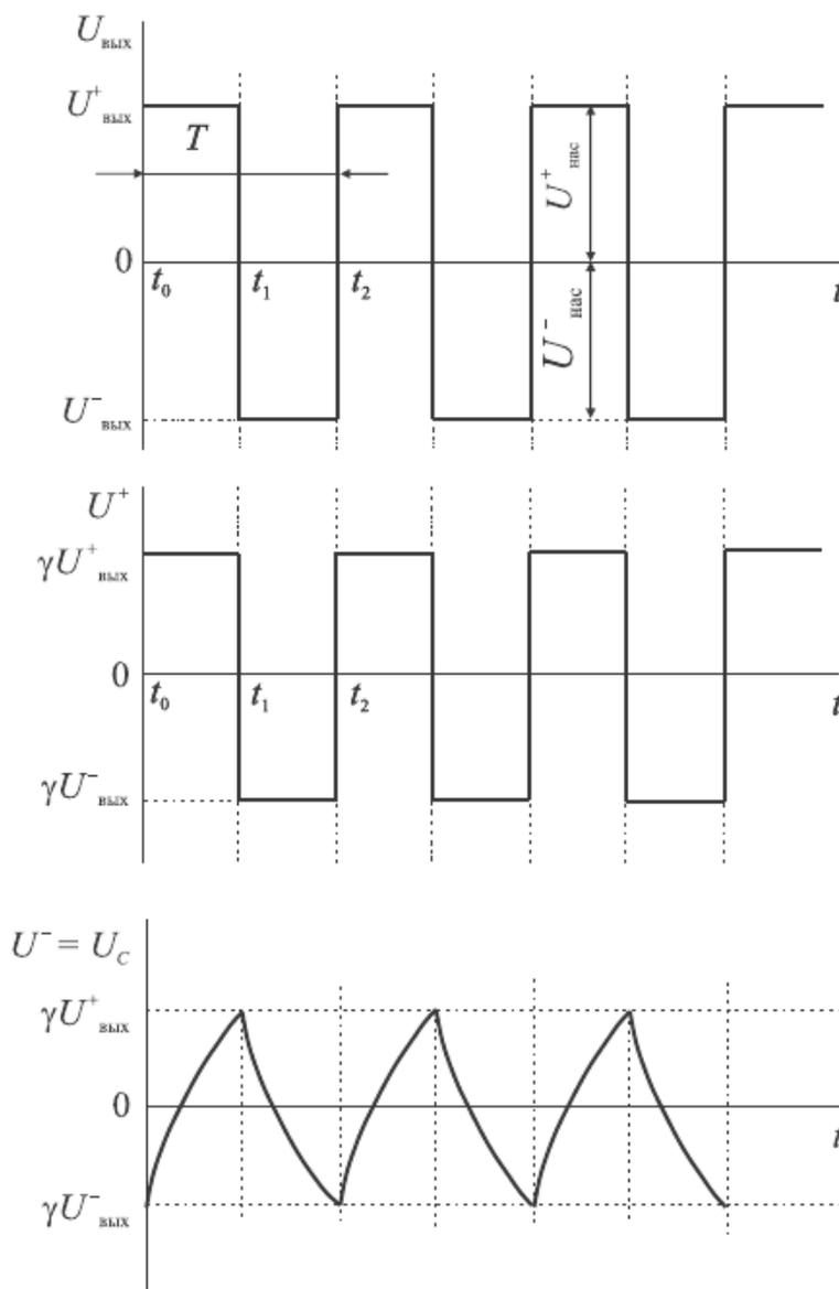
Рис. 2. Временные диаграммы работы мультивибратора в установившемся режиме.
